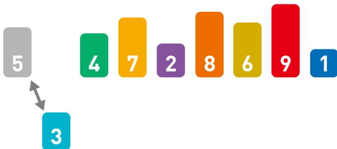
接下来，从待排数字（未排序区域）中取出最左边的数字3，将它与左边已归位的数字进行比较。若左边的数字更大，就交换这两个数字。重复该操作，直到左边已归位的数字比取出的数字更小，或者取出的数字已经被移到整个序列的最左边为止。
